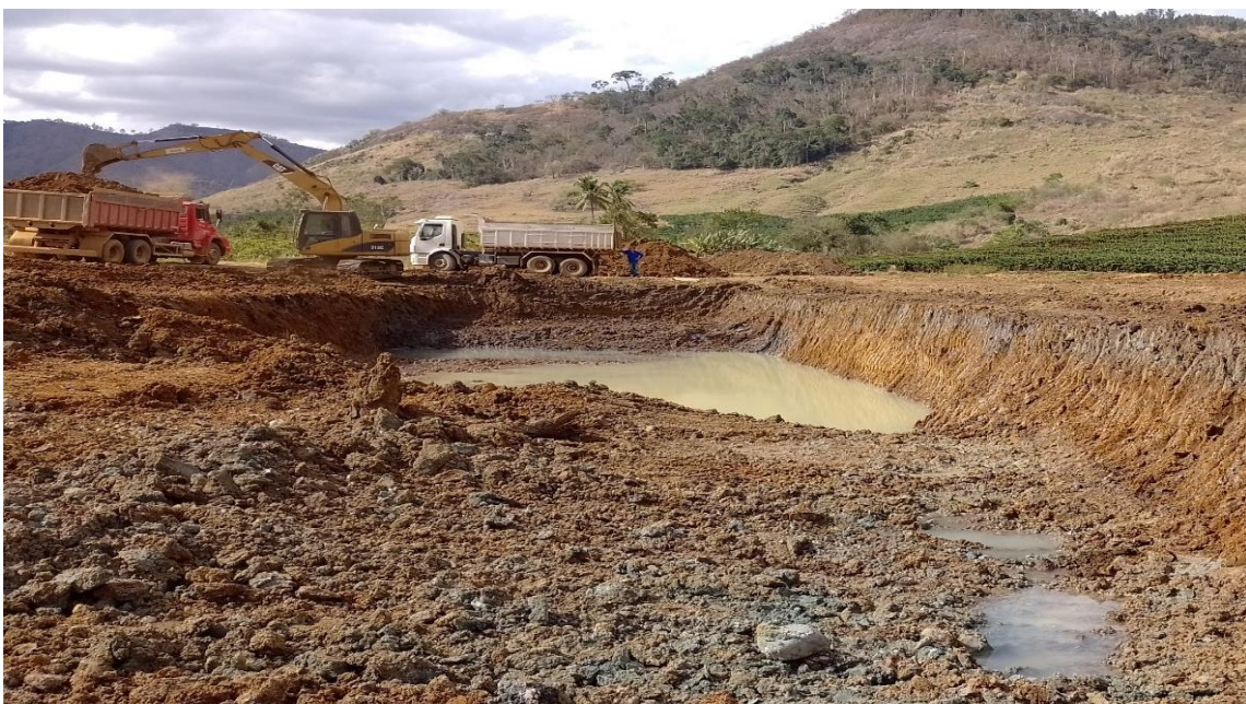
Figure 1. Extração de argila para produção de cerâmica vermelha em São Roque do Canaã – ES.
