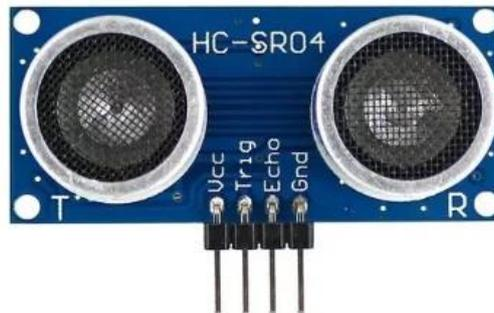
Figura 2 – Sensor ultrassônico HC-SR04.
