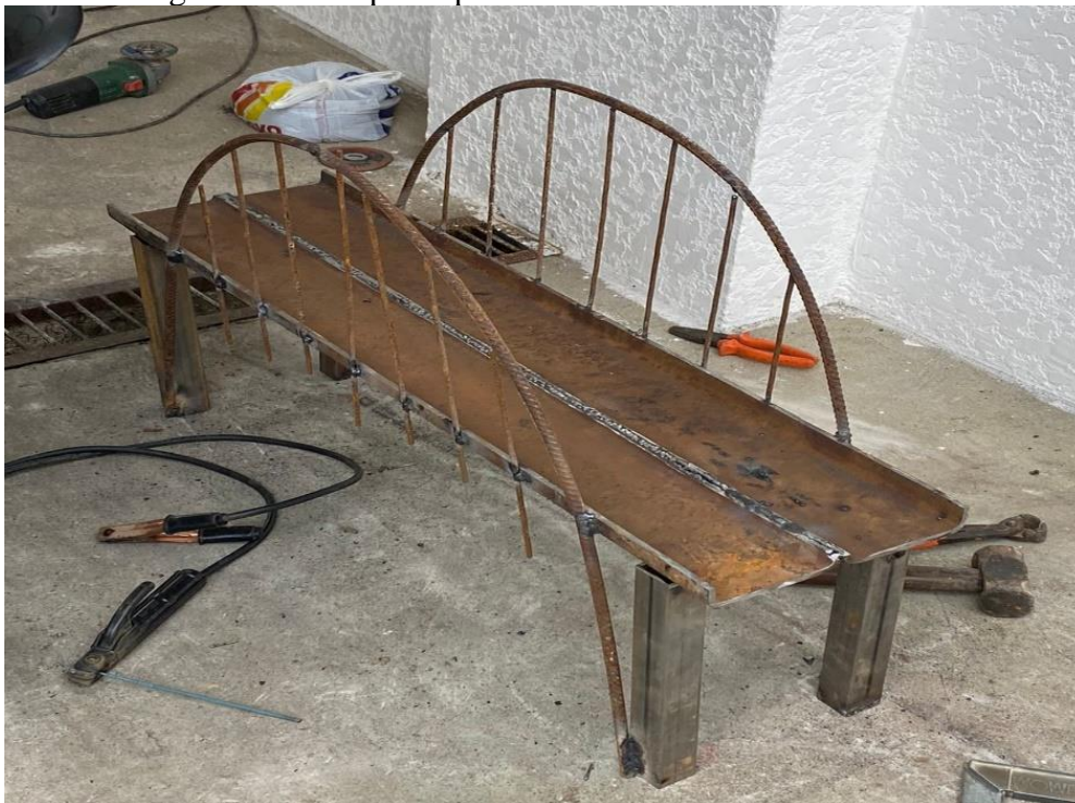
Figura 1. Protótipo da ponte em arco em desenvolvimento
