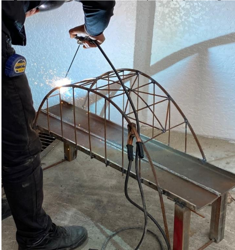
Figura 2. Travamento da estrutura do protótipo por soldagem
