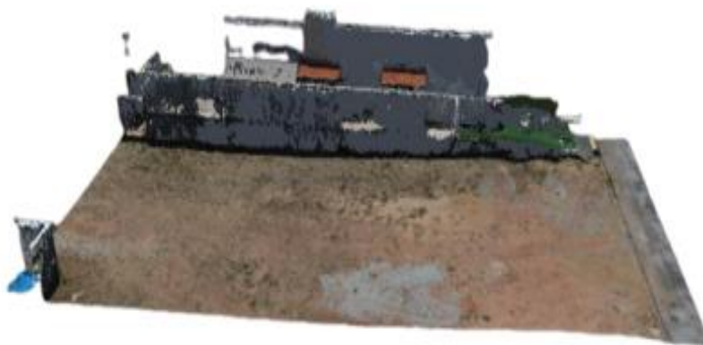
Figura 4 – Modelo Digital de Elevação do Terreno Fonte: Gerada pelos autores no Autodesk ReCap Pro (2024)
