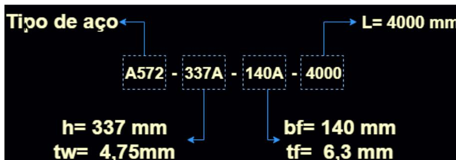
Figura 2-Modelo de código para identificação de vigas
