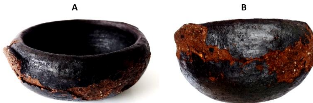
Figura 17 – Exemplo de panela de barro com problemas na etapa de queima.
