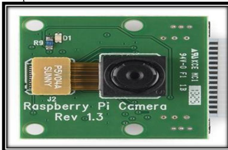
Figura 2 – Câmera Raspberry Pi Rev 1.3 (Fonte: OSHWLab)
