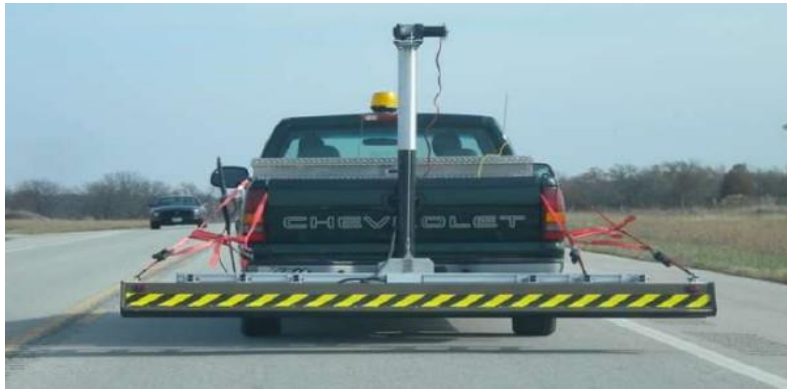
Figura 3 – Sistema GPR Radar 3D para detecção de delaminação. Fonte: AASHTO e FHWA (2018).
