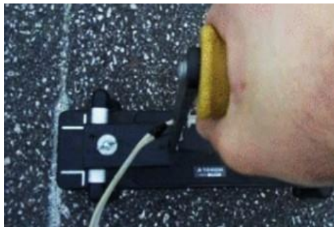
Figura 4 – Dispositivo de tomografia ultrassônica (MIRA). Fonte: Hoegh et al. (2012).
