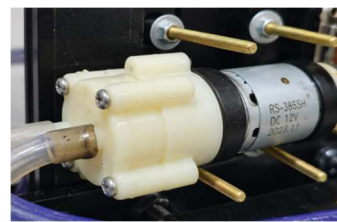
Figura 2 – (a) Módulo sensor de pressão para medição do nível e (b) Minibomba para transferência de água entre o reservatório e os tanques (Fonte: arquivo dos autores).
