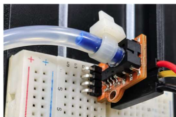
Figura 2 – (a) Módulo sensor de pressão para medição do nível e (b) Minibomba para transferência de água entre o reservatório e os tanques (Fonte: arquivo dos autores).
