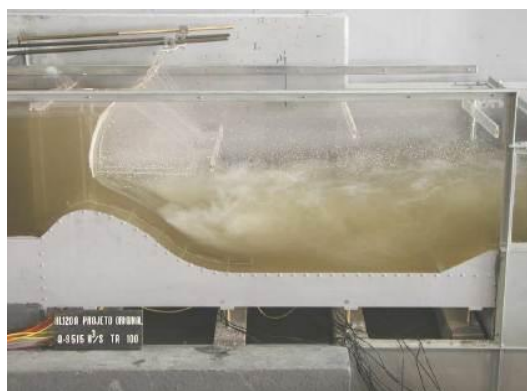
Figura 4 – Ensaio com a vazão de 113,7 L/s (9515 m 3 /s em protótipo) Fonte: CEHPAR (2002)
