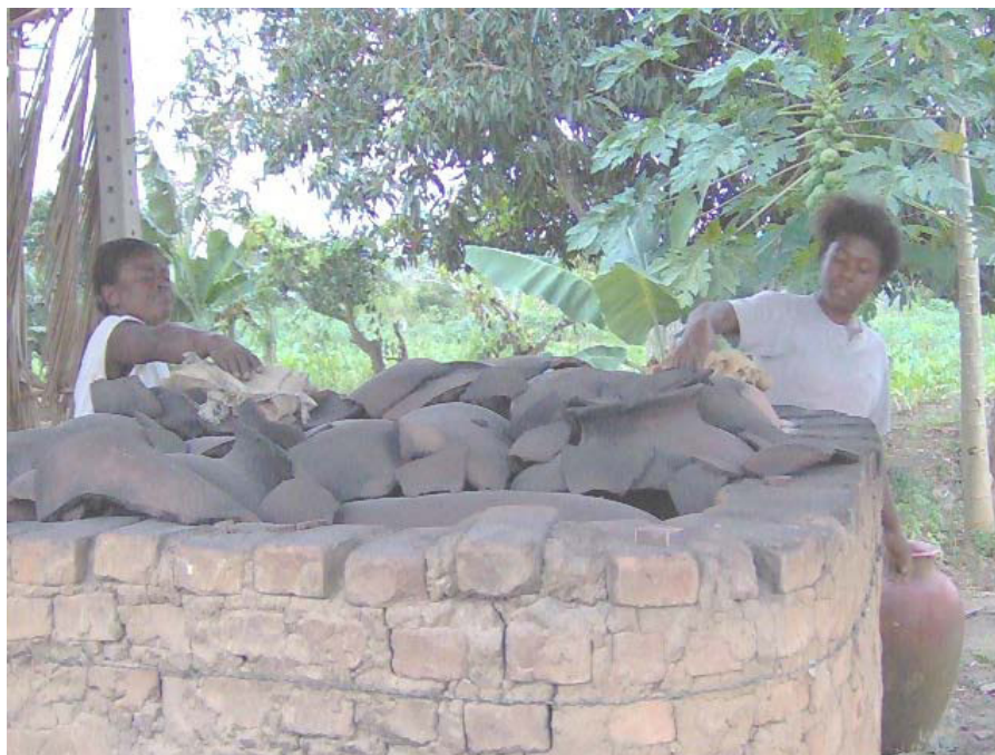
FIGURA 5. Processo da queima das peças de cerâmica.
